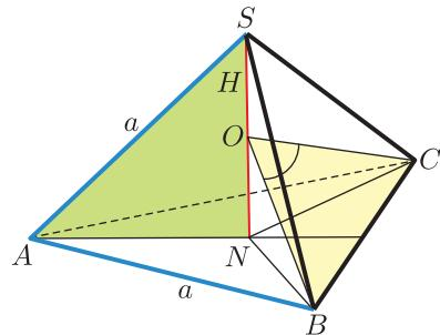
**577.** Izrazićemo zapreminu preko dužine  $a$  ivice tetraedra. Iz pravouglog trougla  $SAN$ , slika desno, vidimo da je  $H^2 = SA^2 - AN^2 = a^2 - \left(\frac{a\sqrt{3}}{3}\right)^2 = \frac{6a^2}{9}$ , pa je  $H = \frac{a\sqrt{6}}{3}$ . Zapremina je  $V = \frac{1}{3} \frac{a^2\sqrt{3}}{4} \cdot \frac{a\sqrt{6}}{3} = \frac{a^3\sqrt{2}}{12}$ . Sada iz  $\frac{a^3\sqrt{2}}{12} = 18\sqrt{2}$  dobijamo  $a^3 = 216$ , pa je  $a = 6$  cm.
